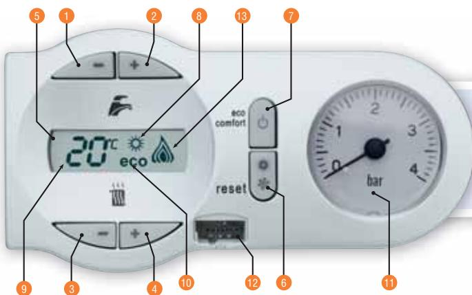
1-2 Регулирование температуры ГВС 3-4 Регулирование температуры системы центрального отопления 5 Дисплей 6 Летний/зимний режим и кнопка возврата 7 Режим экономии/комфорта и кнопка выключения 8 Отображается летний режим (обогрев выключен) 9 Температура и коды отклонений 10 Отображается режим экономии (режим комфорта выключен) 11 Манометр 12 Сервисный разъем 13 Работа горелки
